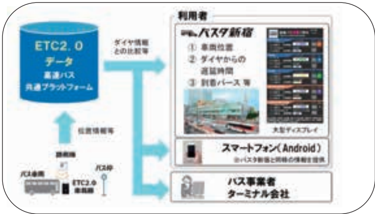
ETC2.0高速バスロケーションシステムイメージ
