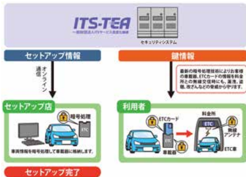
ITS-TEA 発行の鍵による暗号処理とセキュリティ確保の概念
